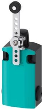
interruttore di posizione con leva girevole regolabile in lunghezza con griglia di fori custodia in metallo XL, larga 56 mm Protezione anticorrosione aumentata collegamento apparecchio 3 x (M20 x 1,5) 2 x (1NO/1NC) contatti ad azione rapida funzionante a -40 °C prova di resistenza a urti e vibrazioni secondo DIN EN 61373, categoria 1B
