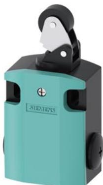
interruttore di posizione custodia in metallo larga 56 mm connessione dell'apparecchio 3x (M20x 1,5) contatti ad azione rapida 1NO/1NC leva con rotella, leva in metallo e rotella in plastica 22 mm
