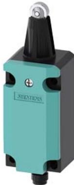
interruttore di posizione custodia in metallo 40 mm secondo EN 50041, contatti ad azione rapida 1NO/1NC, con 2 LED, giallo/verde, DC 24 V, pulsante con rotella con rotella in acciaio inox 13 mm assegnazione dei pin: pin1=21, pin2=22, pin3=13 e LED verde, pin4=14 e LED giallo, pin5=massa LED
