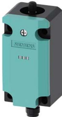
interruttore base per interruttore di posizione 3SE51 custodia in metallo 40 mm secondo DIN EN 50041 contatti ad azione lenta 1NO/1NC con connettore M12, a 5 poli, fisso con 2 LED, giallo/verde, DC 24 V senza testina di comando
