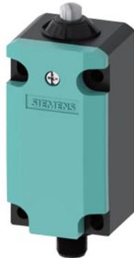
interruttori di posizione con pulsante semplice, pulsante in acciaio inox custodia in metallo 40 mm secondo EN 50041. Collegamento dell'apparecchio con connettore M12, a 5 poli, fisso contatti ad azione rapida 1NO/2NC (2NC e PE collegati) max. 125 V, 4 A. pin1=21, pin4=22, pin2=31, pin5=32, pin3=PE. Adatto per il collegamento con tutti i gruppi di SIMATIC ET200\*, unità di periferia a blocco compatte.
