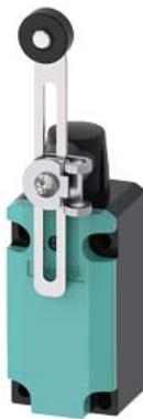
interruttore di posizione custodia in metallo 40 mm secondo DIN EN 50041 collegamento apparecchio 1x (M20 x 1,5) contatti ad azione rapida 1NO/2NC impostabile con leva in metallo lunga 100 mm regolabile in lunghezza e rotella in plastica 19 mm
