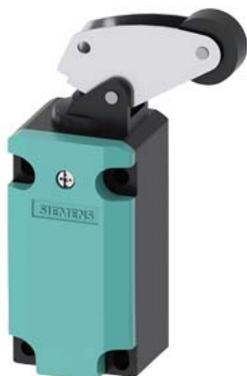
interruttore di posizione custodia in metallo 40 mm secondo DIN EN 50041 collegamento apparecchio 1x (M20 x 1,5) contatti ad azione rapida 1NO/1NC leva angolare con rotella, leva in metallo e rotella in plastica 22 mm
