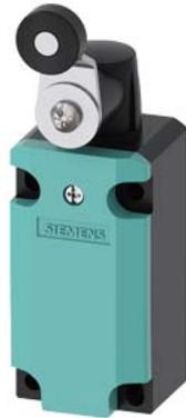
interruttore di posizione custodia in metallo 40 mm leva girevole, secondo EN 50041 collegamento apparecchio 1 x (M20 x 1,5) contatti ad azione lenta 1NO/1NC attuatore a frazione di giro a destra/a sinistra impostabile, leva in metallo 27 mm di lunghezza e rotella in plastica 19 mm
