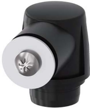
azionatore con leva girevole (ordinare la leva separatamente) per interruttore di posizione, 3SE51/3SF11, per 40/56/56XL mm, punti di commutazione secondo EN 50041. La direzione di commutazione della leva è impostabile a sinistra/destra oppure solo sinistra o solo destra. Stato di fornitura è a destra/sinistra.
