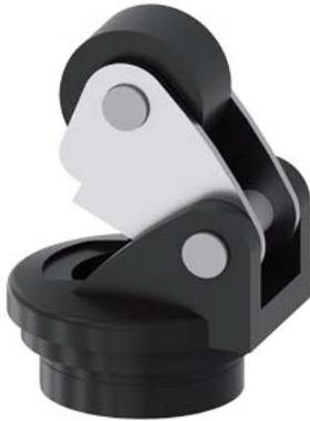
testina di comando per interruttori di posizione 3SE51/52 leva con rotella, Forma E con leva in acciaio inox e rotella in plastica 13 mm secondo DIN EN 50047
