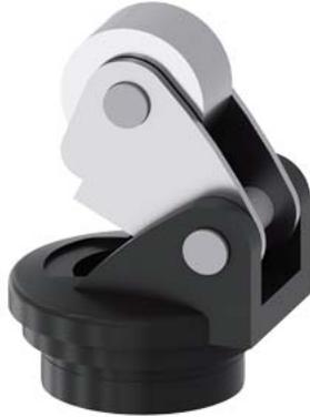
testina di comando per interruttori di posizione 3SE51/52 leva con rotella, Forma E con leva in metallo e rotella in acciaio inox 13 mm secondo DIN EN 50047
