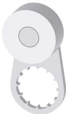
leva girevole per interruttori di posizione 3SE52 leva in acciaio inox lunga 21 mm, Forma A con rotella in acciaio inox 19 mm secondo DIN EN 50047
