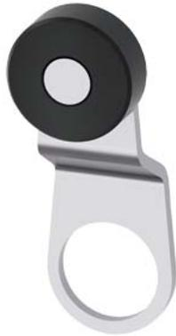
leva girevole per interruttore di posizione 3SE51 leva in metallo lunga 35 mm livello 9 mm con rotella in plastica 19 mm
