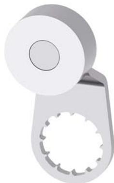
leva girevole per interruttore di posizione 3SE51 leva in acciaio inox, Forma A lunga 27 mm livello 9 mm con rotella in acciaio inox 19 mm secondo DIN EN 50041
