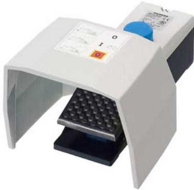
interruttore a pedale di sicurezza a 1 pedale, con calotta di protezione, IP65, con funzione di interblocco, 2NO+2NC, contatto NO, chiude ad impulso, contatto NC, apre con ritenzione simultanea (funzione di sicurezza), ingresso cavi M20 x 1,5
