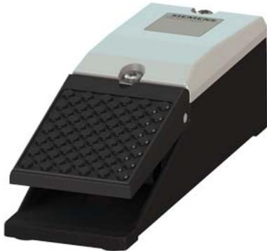
pulsante a pedale, a 1 pedale senza calotta, senza ritenzione meccanica custodia in metallo IP65, 2NO+2NC, ingresso cavi M20 x 1,5
