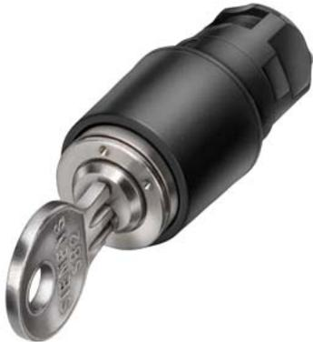
selettore a chiave, 16 mm, rotondo, plastica, CES, SB2, 2 posizioni di commutazione O-I, permanente, angolo di comando 62° estrazione chiave O+I, possibili serrature speciali: SB3, SB4, SB5
