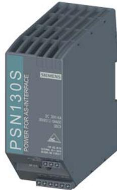
PSN130S 4A AC 120V/230V IP20 alimentatore 30 V, AS-i senza disaccoppiamento dati AS-i IN: AC 120 V / 230 V OUT: DC 30 V, 4 A, IP20 con rilevamento di sovraccarico con contatto di segnalazione
