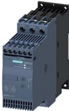
SIRIUS softstarter S0 38 A, 18,5 kW/400 V, 40 °C AC 200-480 V, AC/DC 110-230 V morsetti a vite
