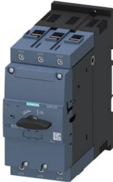
interruttore automatico grandezza costruttiva S3 per avviatore combinato corrente nominale 50 A sganciatore N 650 A morsetto a vite potere di interruzione elevato 100 kA
