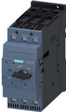
interruttore automatico grandezza costruttiva S2 per avviatore combinato corrente nominale 40 A sganciatore N 585 A morsetto a vite elevato potere di interruzione
