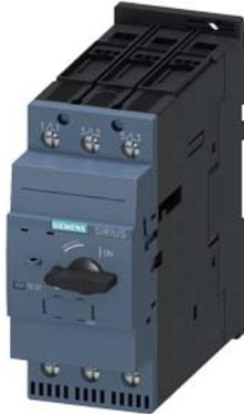
interruttore automatico grandezza costruttiva S2 per avviatore combinato corrente nominale 65 A sganciatore N 845 A morsetto a vite potere di manovra standard
