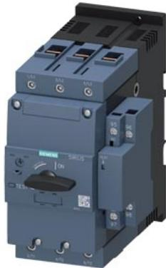
interruttore automatico grandezza costruttiva S3 per protezione motore Classe 10 con funzione di relè di sovraccarico sganciatore A 65...84 A sganciatore N 1170 A morsetto a vite potere di interruzione elevato 100 kA
