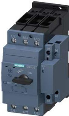
interruttore automatico grandezza costruttiva S2 per protezione motore, CLASS 10 con funzione di relè di sovraccarico Sganciatore A 32...40 A sganciatore N 585 A potere di manovra standard
