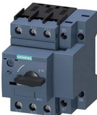
interruttore automatico grandezza costruttiva S0 per protezione motore, CLASS 10 con funzione di relè di sovraccarico sganciatore A 13...20 A sganciatore N 260 A morsetto a vite potere di manovra standard
