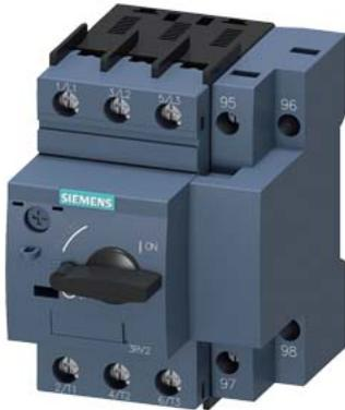
interruttore automatico grandezza costruttiva S00 per protezione motore, CLASS 10 con funzione di relè di sovraccarico sganciatore A 10...16 A sganciatore N 208 A morsetto a vite potere di manovra standard
