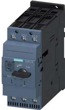
interruttore automatico grandezza costruttiva S2 per protezione motore, CLASS 20 sganciatore A 42 ... 52 A sganciatore N 741 A morsetto a vite potere di manovra standard
