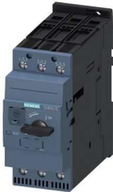
tipo speciale interruttore automatico grandezza costruttiva S2 per protezione motore, CLASS 10 sganciatore A 54...65 A sganciatore N 845 A morsetto a vite potere di manovra standard temperatura ambiente -50 °C 250 cicli di manovra
