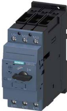
interruttore automatico grandezza costruttiva S2 per protezione motore, CLASS 10 sganciatore A 22...32 A sganciatore N 416 A morsetto a vite potere di manovra standard
