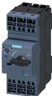
interruttore automatico grandezza costruttiva S0 per protezione motore, CLASS 10 sganciatore A 9...12 A sganciatore N 163 A morsetto a molla potere di manovra 30 kA con 600 V secondo UL/CSA
