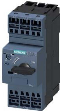
tipo speciale interruttore automatico grandezza costruttiva S0 per protezione motore, CLASS 10 sganciatore A 23...28 A sganciatore N 364 A morsetto a molla potere di manovra standard temperatura ambiente -50 °C 500 cicli di manovra
