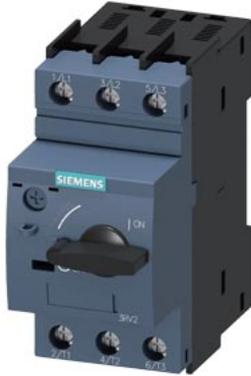
interruttore automatico grandezza costruttiva S0 per protezione motore, CLASS 10 sganciatore A 34...40 A sganciatore N 480 A morsetto a vite potere di manovra standard
