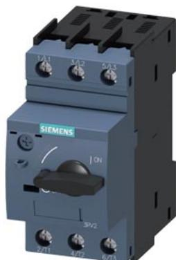
interruttore automatico grandezza costruttiva S0 per la protezione impianto senza protezione contro la mancanza di fase sganciatore A 13 ... 20 A sganciatore N 260 A morsetti a vite potere di interruzione standard
