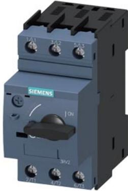
interruttore automatico grandezza costruttiva S0 per la protezione impianto senza protezione contro la mancanza di fase sganciatore A 9 ... 12,5 A sganciatore N 163 A morsetti a vite potere di interruzione standard
