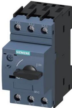
interruttore automatico grandezza costruttiva S0 per protezione motore, CLASS 10 sganciatore A 3,5...5 A sganciatore N 65 A morsetto a vite potere di manovra standard
