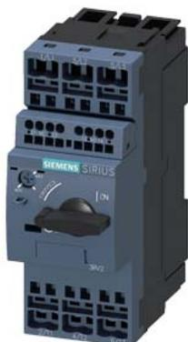
interruttore automatico grandezza costruttiva S0 per protezione motore, CLASS 10 sganciatore A 2,2...3,2 A sganciatore N 42 A morsetto a molla potere di manovra standard con blocchetto di contatti ausiliari frontale 1NO+1NC
