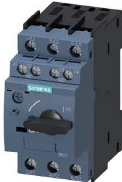
interruttore automatico grandezza costruttiva S0 per protezione motore, CLASS 10 sganciatore A 1,1...1,6 A sganciatore N 21 A morsetto a vite potere di manovra standard con blocchetto di contatti ausiliari frontale 1NO+1NC
