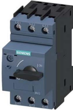
tipo speciale interruttore automatico grandezza costruttiva S00 per protezione motore, CLASS 10 sganciatore A 10...16 A sganciatore N 208 A morsetto a vite potere di manovra standard temperatura ambiente -50 °C 500 cicli di manovra
