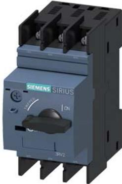
interruttore automatico grandezza costruttiva S00 per protezione motore, CLASS 10 sganciatore A 9...12 A sganciatore N 163 A collegamento con capocorda ad occhiello potere di manovra standard
