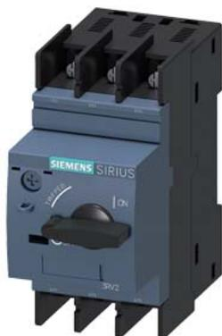
interruttore automatico grandezza costruttiva S00 per protezione motore, CLASS 10 sganciatore A 5,5...8 A sganciatore N 104 A collegamento con capocorda ad occhiello potere di manovra standard
