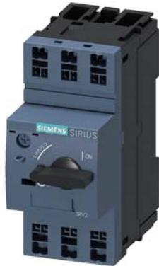
tipo speciale interruttore automatico grandezza costruttiva S00 per protezione motore, CLASS 10 sganciatore A 1,1...1,6 A sganciatore N 21 A morsetto a molla potere di manovra standard temperatura ambiente -50 °C 500 cicli di manovra
