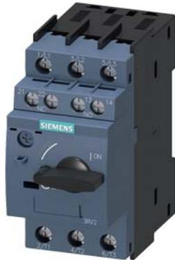
interruttore automatico grandezza costruttiva S00 per protezione motore, CLASS 10 sganciatore A 0,7...1 A sganciatore N 13 A morsetto a vite potere di manovra standard con blocchetto di contatti ausiliari frontale 1NO+1NC
