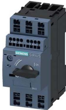
interruttore automatico grandezza costruttiva S00 per protezione motore, CLASS 10 sganciatore A 0,55...0,8 A sganciatore N 10 A morsetto a molla potere di manovra standard con blocchetto di contatti ausiliari frontale 1NO+1NC
