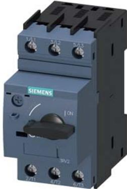
interruttore automatico grandezza costruttiva S00 per protezione motore, CLASS 10 sganciatore A 0,45...0,63 A sganciatore N 8,2 A morsetto a vite potere di manovra standard
