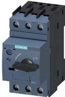
interruttore automatico grandezza costruttiva S00 per protezione motore, CLASS 10 sganciatore A 0,28...0,4 A sganciatore N 5,2 A morsetto a vite potere di manovra standard
