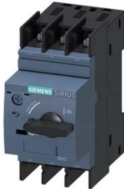
interruttore automatico grandezza costruttiva S00 per protezione motore, CLASS 10 sganciatore A 0,22...0,32 A sganciatore N 4,2 A collegamento con capocorda ad occhiello potere di manovra standard
