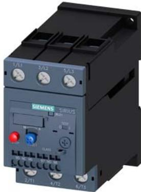
relè di sovraccarico 36...45 A termico per protezione motore grandezza costruttiva S2, CLASS 10 montaggio separato circuito principale: morsetti a vite circuito ausiliario: morsetti a molla reset manuale-automatico
