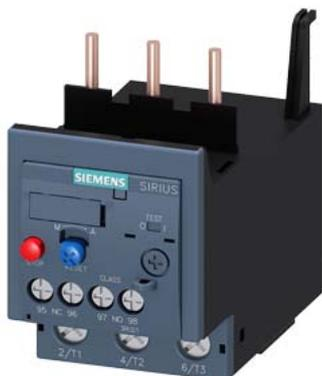
relè di sovraccarico 28...40 A termico per protezione motore grandezza costruttiva S2, CLASS 10 montaggio su contattore circuito principale: morsetti a vite circuito ausiliario: morsetti a vite reset manuale-automatico
