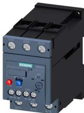
relè di sovraccarico 22...32 A termico per protezione motore grandezza costruttiva S2, CLASS 10 montaggio separato circuito principale: morsetti a vite circuito ausiliario: morsetti a vite reset manuale-automatico
