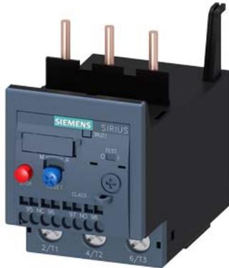
relè di sovraccarico 18...25 A termico per protezione motore grandezza costruttiva S2, CLASS 10 montaggio su contattore circuito principale: morsetti a vite circuito ausiliario: morsetti a molla reset manuale-automatico
